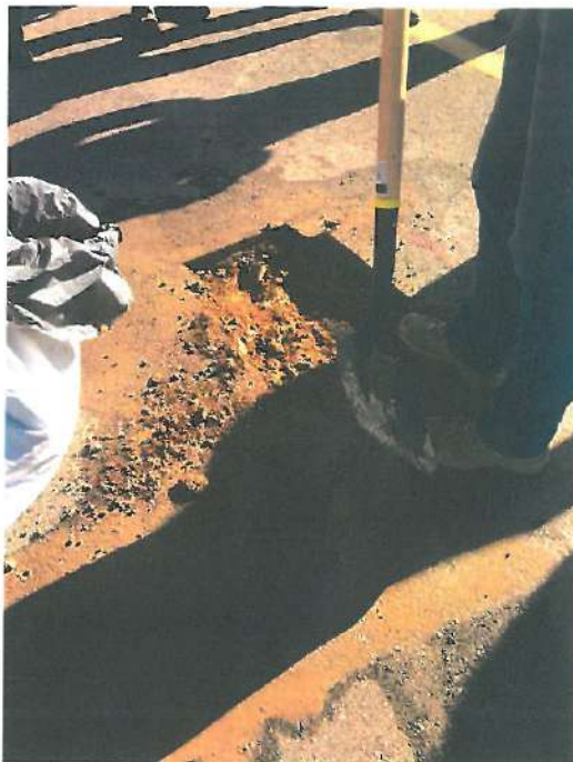
EXTRACCION DE BASE HIDRAULICA PARA SU ANALISIS
