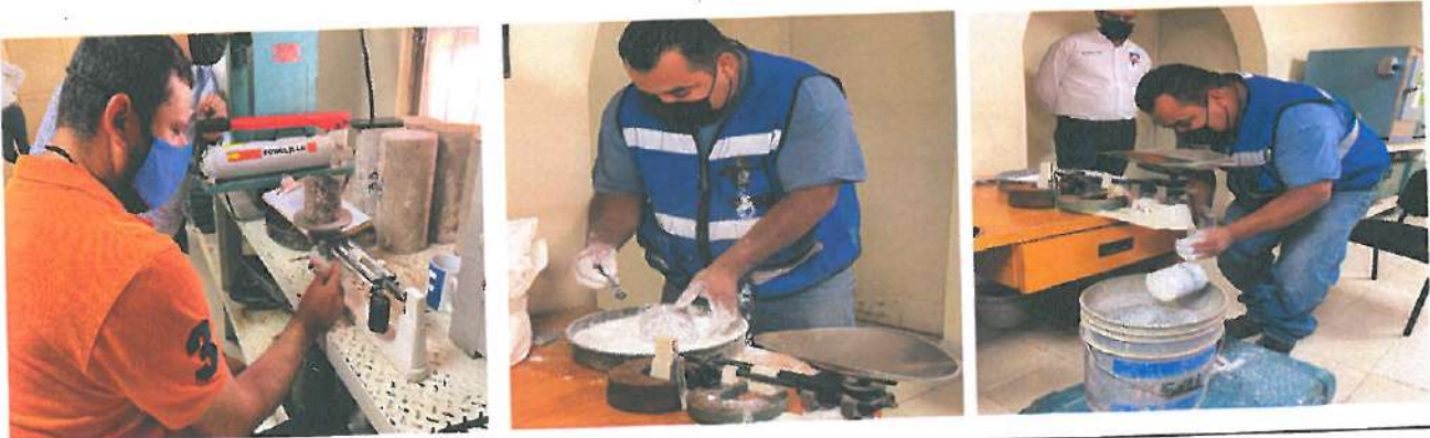
Procesos realizados en Laboratorio de Materiales para Obtener el "Porcentaje de Compactación a los 22 Núcleos Extraídos de Carpeta Asfáltica"
