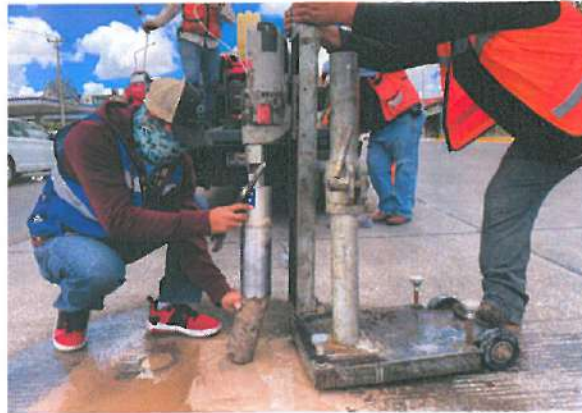
Etapa de Extracciones de Núcleos de Concreto, utilizando broca de 4"
