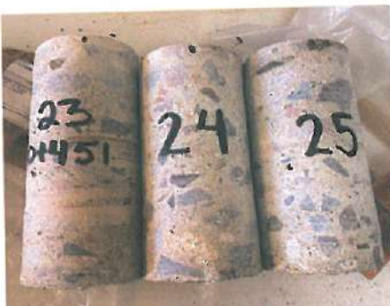
Etapa de Verificación de Espesores de los 3 Núcleos Extraídos en Carpeta de Concreto Hidráulico.
