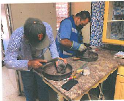
Etapa Desprendimiento de Material en carpeta de forma manual y maquina de corte.
