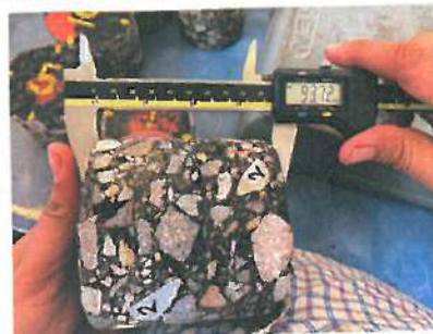
Etapa de Verificación de Espesores de los 22 Núcleos Extraídos en carpeta Asfáltica
