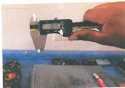
Etapa de Verificación de Espesores de los 22 Núcleos Extraídos en carpeta Asfáltica
