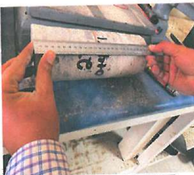
Etapa de Verificación de Espesores de los 3 Núcleos Extraídos en Carpeta de Concreto Hidráulico.
