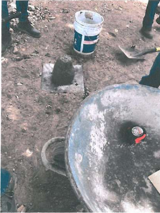
SE REALIZO LA PRUEBA DEL REVENIMIENTO DEL CONCRETO Y TOMA DE MUESTRAS DE CUATRO CILINDROS DE CONCRETO PARA SU FUTURO ENSAYE
