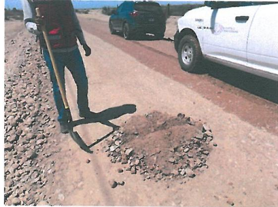
UNA VEZ REALIZADOS LOS CAJONES CORRESPONDIENTES SE PROCEDIÓ A TRASPLEAR Y HOMOGENIZAR LA MUESTRA PARA DESPUÉS CUARTEAR Y COLOCAR EN SU SACO; PARA SER EVALUADO EN EL LABORATORIO
