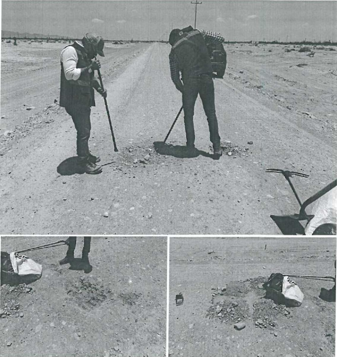
En la verificación física, se procedió a la revisión de la capa de material de subrasante, el cual se tiene tendida hasta el cadenamiento 2+200 conformada por 30 cm. Se procedió a toma de muestra de material subrasante en cadenamiento 1+500 del cual representa del cadenamiento 1+400 al 1+700. La muestra se tomó para su análisis en laboratorio, realizando un cajón de 40 x 40 cm en todo el espesor de la capa, la cual cumple con los 30 cm contemplados.
