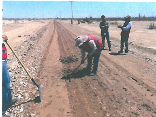
En la verificación física se procedió a la realización de cajones en la capa del material subrasante en los cadenamamientos 0+218 y 0+797 para poder evaluar su calidad.
