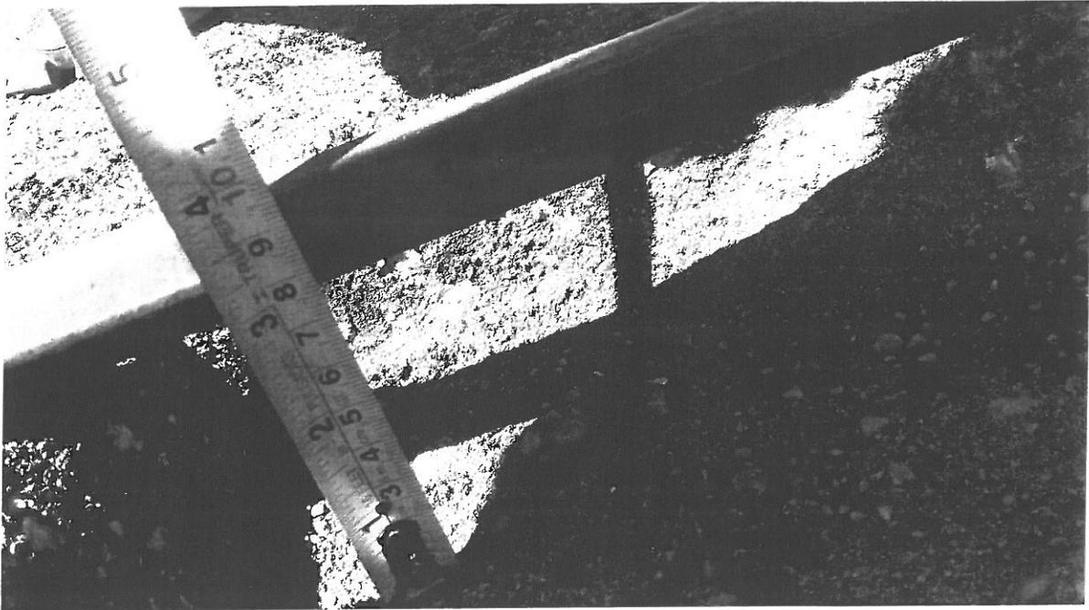
EN LAS TOMAS FOTOGRAFICAS SE APRECIA A PERSONAL DE LA JUNTA DE CAMINO DEL ESTADO DE SONORA Y DE CONTROLORIA, CHECANDO ESPESORES DE LAS CAPAS DE LA CARPETA ASFALTICA Y DE BASE HIDRAULICA, LAS CUALES CORRESPONDEN A LO ESPECIFICADO EN PROYECTO.
