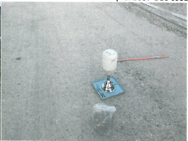
Muestreo de capa de sub-base para determinar su calidad y la realización de pruebas de compactación con el método de cono y arena.
